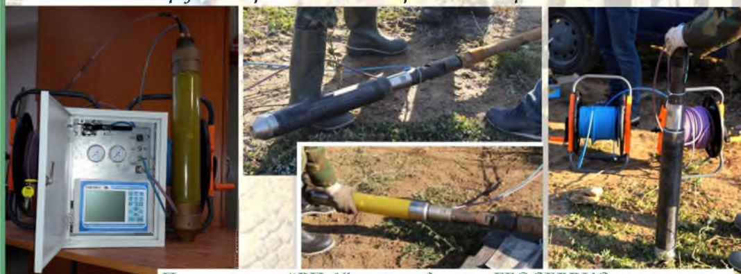
Прессиометр "РП-1" производства «ГЕОСЕРВИС». Испытания на площадке "Минск Мир" (2016 г.)
