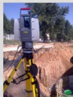
Лазерный сканер Leica Scanstation2
