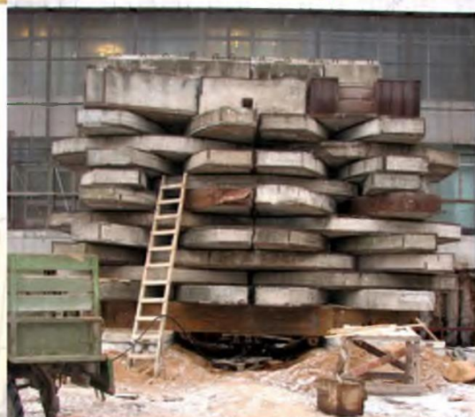
Испытания грунтов буронабивными сваями (Минск, 2008-2009 гг.)
