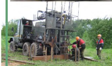
Станции пенетрационного каротажа (СПК, СПКТ), перепрофилированные для целей статического зондирования
