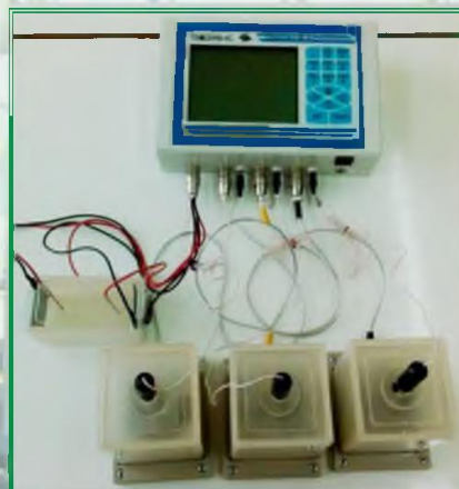
Прибор "ОКА" для определения коррозионной агрессивности грунта (производство «ГЕОСЕРВИС»)
