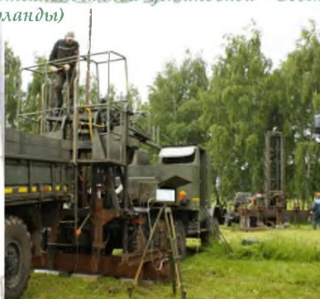
Станции пенетрационного каротажа (СПК, СПКТ), перепрофилированные для целей статического зондирования
