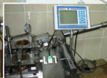
Автоматизированное оборудование одно- плоскостного среза
