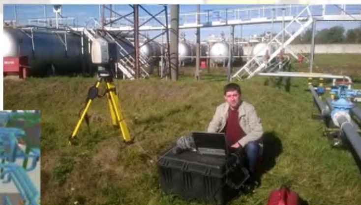
3D-сканирование газонаполнительной станции (Гродно, 2015 г.)
