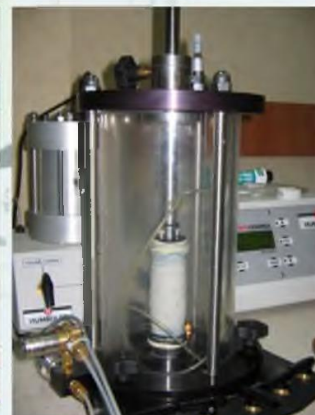
Трёхосные испытания грунтов (оборудование "Humboldt", США)
