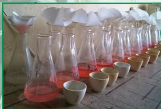
Химический анализ водной вытяжки из грунта
