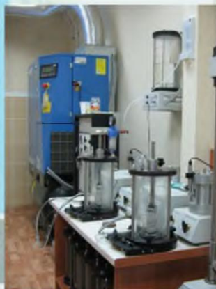
Трёхосные испытания грунтов (оборудование "Humboldt", США)
