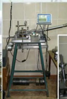
Автоматизированное оборудование одно- плоскостного среза
